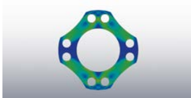
Il design delle lamelle è ottimizzato in base alle norme FEM
